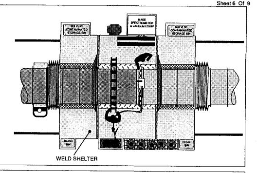
STEP #12 -WELD BEAM TUBE JOINT
