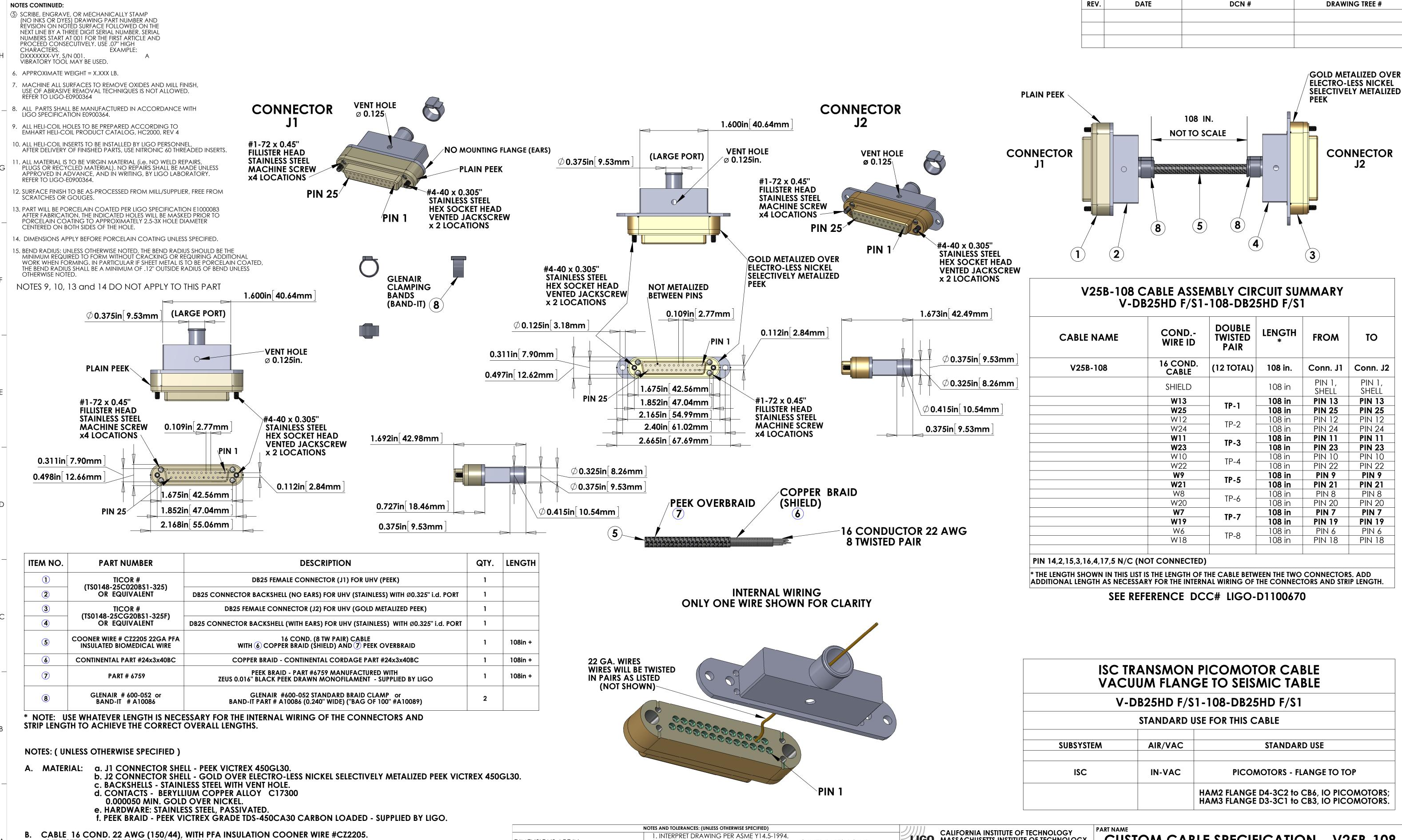
8 TWISTED PAIRS ( 4 TO 5 TWISTS PER INCH ).
